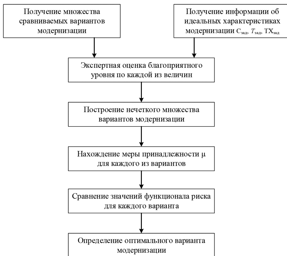
Рис. Структурно-логическая схема методики выбора оптимального варианта модернизации РЛС МКП для достижения требуемых характеристик при ограничениях по стоимости и времени модернизации
