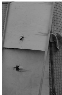
Рис. 4. Результаты обстрела ГНТ-2 противотанковыми гранатами ПГ-7ВЛ: а — входные отверстия; б — выходные отверстия
