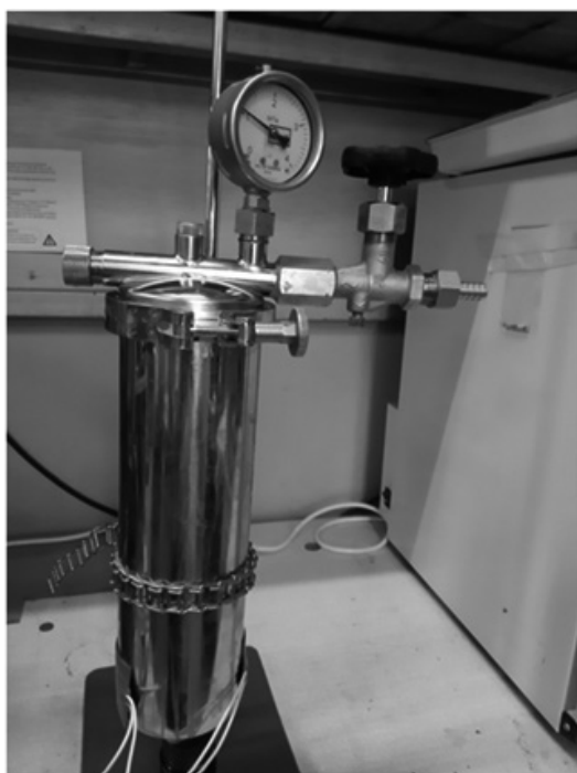
Рис. 4. Генератор водорода периодического действия в сборке. Объем рабочей полости реактора гидролиза 1,9 л. Температура в реакторной зоне 40 °С. Давление 11,2 атм.
