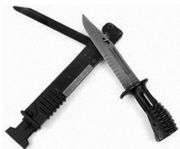
Рис. 6. Общий вид ножен для L3A1 с установленным для использования в роли «кусачек» штык-ножом и разложенной пилой
