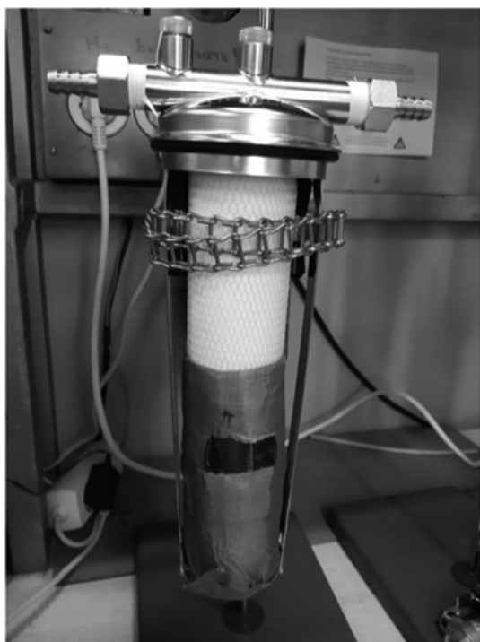
Рис. 2. Реакторный блок ГВ с проточным реактором
