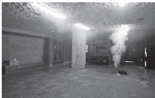
Рис. Испытания АПС на объекте с помощью дымогенератора «Кипарис-П (Ст)»
