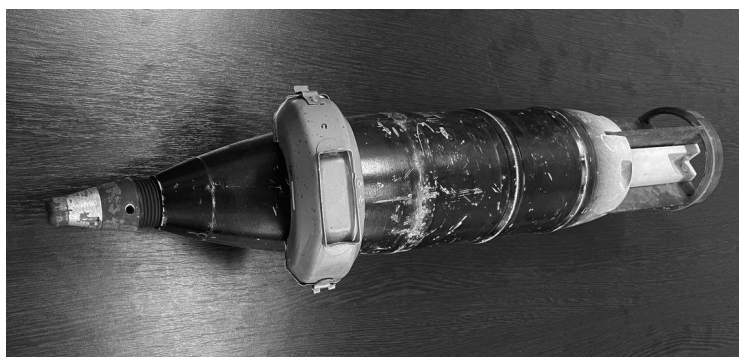
Рис. 7. Размещение полукольцевого заряда КЗК на артиллерийском снаряде перед его обезвреживанием
