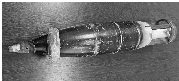
Рис. 8. Размещение заряда ПВВ на артиллерийском снаряде перед его обезвреживанием
