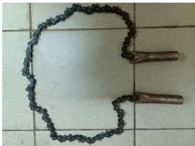
Рис. 7. Экспериментальный образец цепного устройства для кольцевания деревьев на основе пильной цепи ПЦУ-10,26
