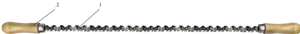
Рис. 5. Цепное устройство для кольцевания деревьев: 1 – режущий орган, 2 – рукоятки
