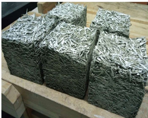
Рис. 1. Образцы арболита Fig. 1. Samples of arbolite
