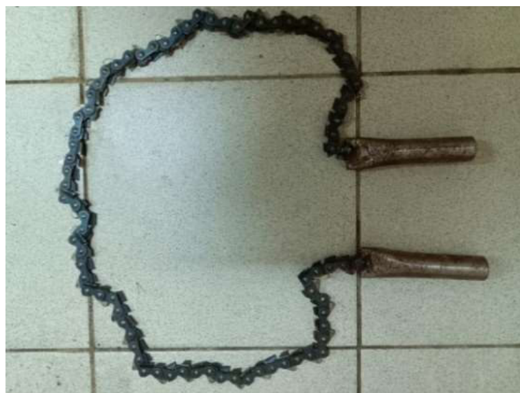
Рис. 7. Экспериментальный образец цепного устройства для кольцевания деревьев на основе пильной цепи ПЦУ-10,26 Fig. 7. An experimental sample of the chain device for tree ringing based on a saw chain PCU-10.26
