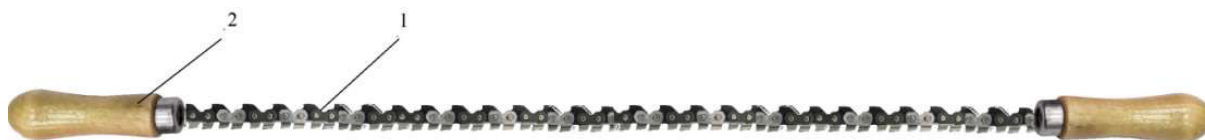
Рис. 5. Цепное устройство для кольцевания деревьев: 1 – режущий орган, 2 – рукоятки Fig. 5. Chain device for tree ringing: 1 – cutting body, 2 – handles
