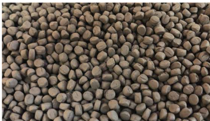
Рис. 4. Гранулят на основе порошка стали 38ХМ
