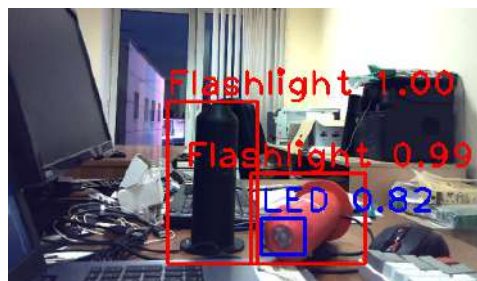
Рис. 3. Демонстрация детектирования сразу нескольких фонарей-меток
