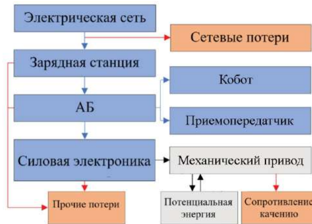
Рис. 2. Схема энергопотребления мобильного робота
