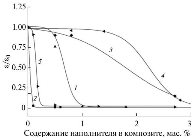
Рис. 8. Зависимость относительного удлинения при разрыве \varepsilon/\varepsilon_0 от содержания наполнителя. Матрица — изотактический ПП. Наполнитель — ГНП, обработанные ультразвуком (1), ГНП (2), фуллерен (3), НГ (4), МУНТ (5).
