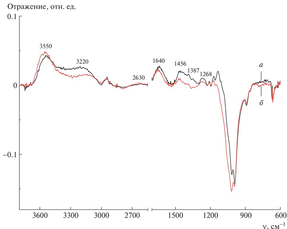
**Рис. 4.** Дифференциальные спектры композитных волокон гидратцеллюлоза–ортоборная кислота, полученных из растворов целлюлозы в ММО, содержащих 19 (а) и 38% (б) ортоборной кислоты за вычетом спектра гидратцеллюлозного волокна.
