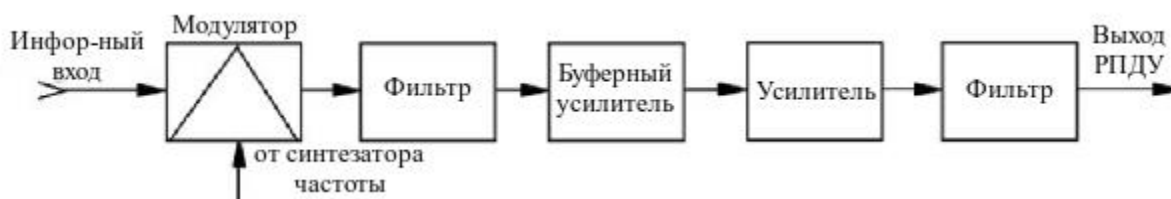
Рисунок 1 – Структура РПДУ с линейным усилением сигналов угловых видов модуляции
