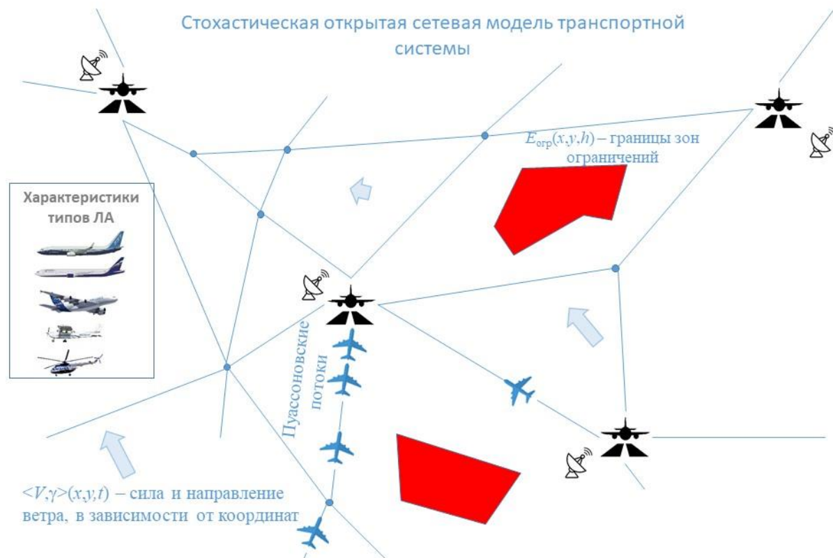
Рисунок 7 – Схема стохастической открытой сетевой модели воздушной обстановки
