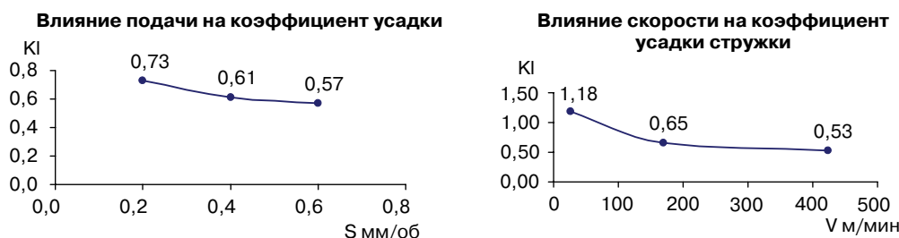
Рис. 2. Влияние элементов режима резания на коэффициент усадки стружки
