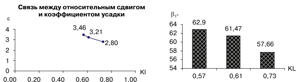
Рис. 4. Влияние подачи на характеристики пластической деформации
