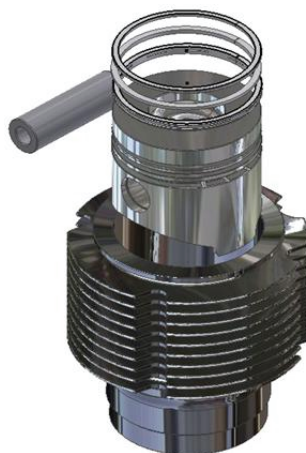
Рис. 2. 3D модели цилиндра, поршня, поршневых колец и поршневого пальца дизеля
