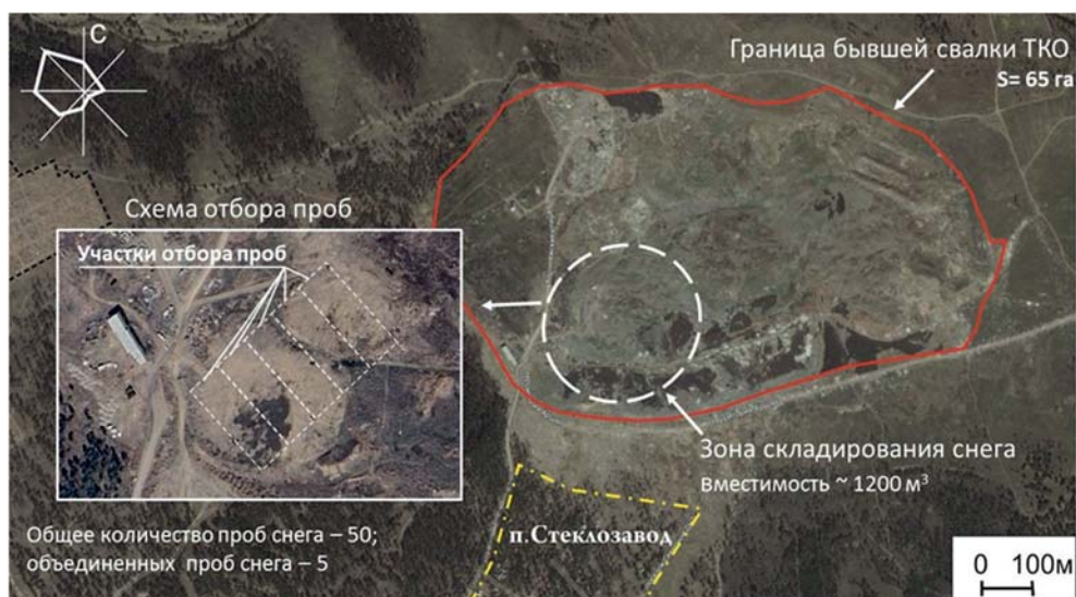
Рис. 1. Схема отбора проб на площадке снегонакопления Источник: составлено Т.В. Чередовой, О.Н. Чудиновой.
