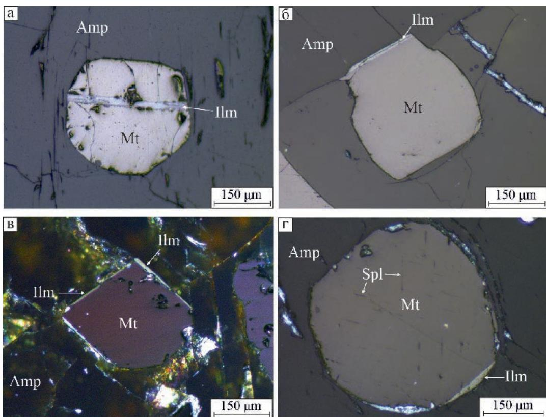
Рис. 7. Взаимоотношения ильменита с кристаллами магнетита: а – единичный кристалл ильменита в магнетите; б – кристалл ильменита на контакте магнетита с амфиболом; в – кристаллы ильменита на контакте трех граней магнетита с амфиболом; г – кристалл ильменита, имеющий плоскую границу с магнетитом и круглую – с амфиболом.
