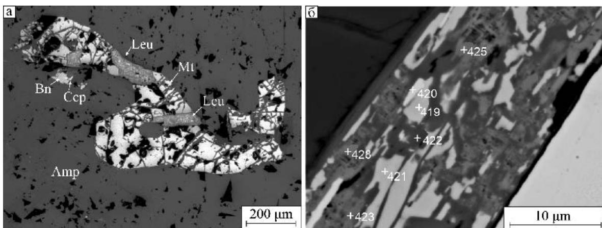
Рис. 13. Индивиды ильменита, замещенные вторичными минералами: а – отраженный свет; б – BSE-фото.
