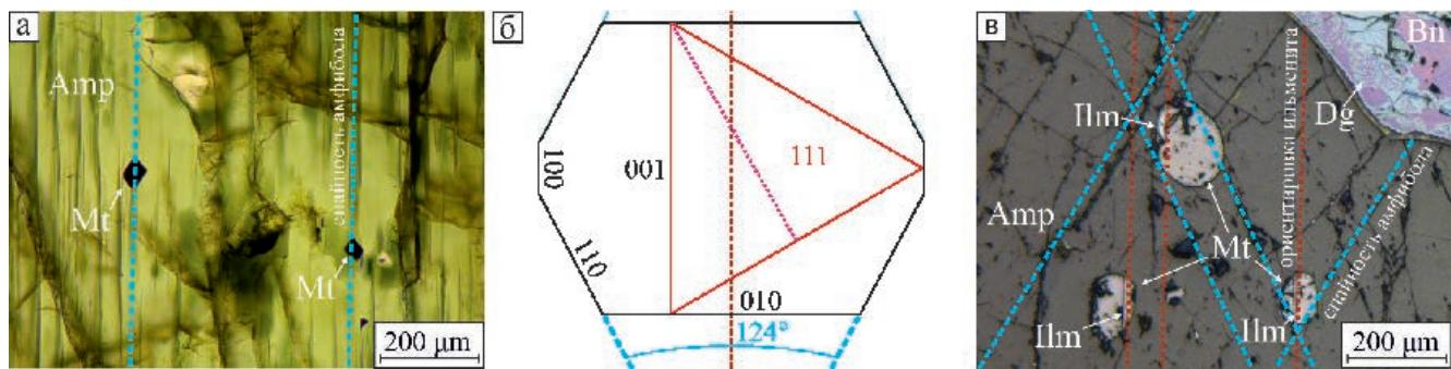
Рис. 5. Закономерно ориентированные срастания магнетита с амфиболом: а – параллельная ориентировка осей четвертого порядка октаэдрических кристаллов магнетита и спайности в амфиболе; б – схема закономерного срастания магнетита и амфиболя; в – параллельная ориентировка пластинчатых кристаллов ильменита в каплевидных выделениях магнетита и ее совпадение с биссектрисой угла между плоскостями спайности в амфибOLE. Отраженный свет с анализатором (а) и без анализатора (в).
