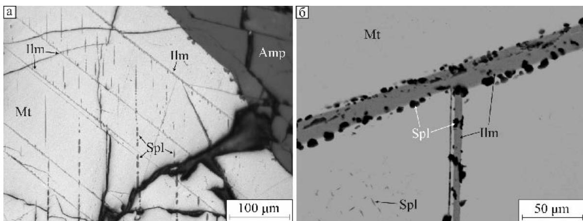
Рис. 9. Закономерно ориентированные выделения ильменита в срастании со шпинелем по отношению к вмещающему кристаллу магнетита: а – отраженный свет; б – BSE-фото.
