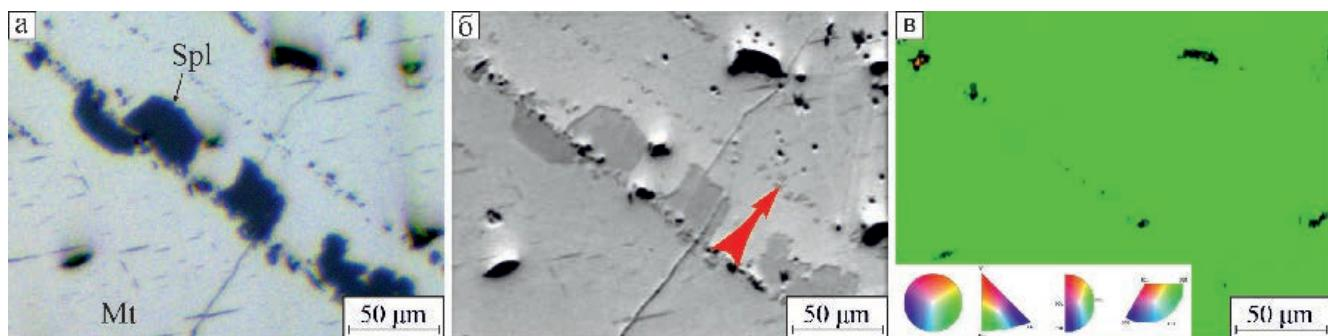
*Рис. 18. Индивиды шпинели, приуроченные к зоне роста кристалла магнетита: а – отраженный свет; б – BSE-фото (стрелка указывает предполагаемое направление роста кристалла магнетита); в – карта распределения ориентировок по данным дифракции обратно-рассеянных электронов, свидетельствующая о единой ориентировке включений шпинели и вмещающего кристалла магнетита.*
