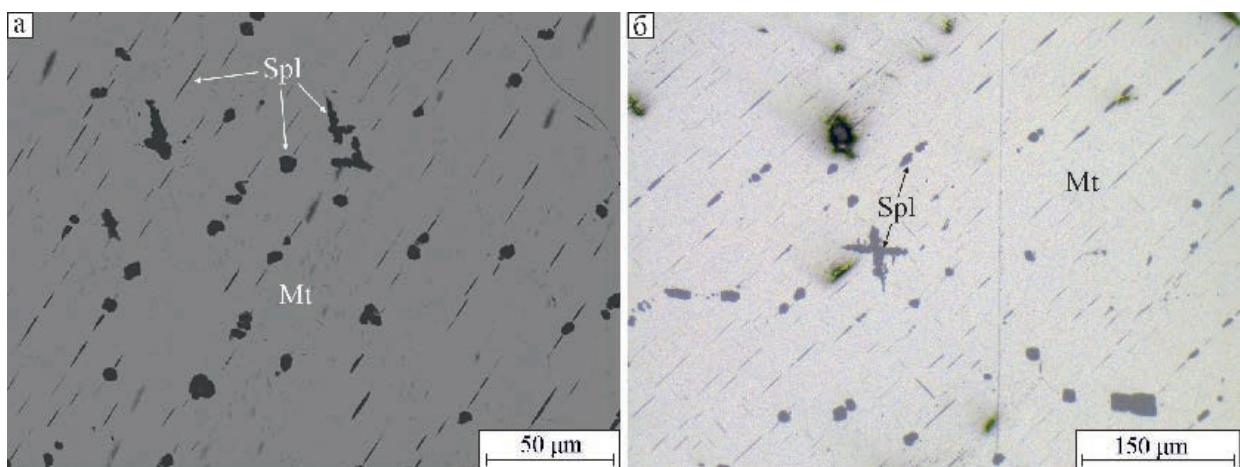
Рис. 14. Пластиинки шпинели по {100} и скелетные кристаллы шпинели по {111} в магнетите, возникшие в результате распада твердого раствора: а – BSE-фото; б – отраженный свет.
