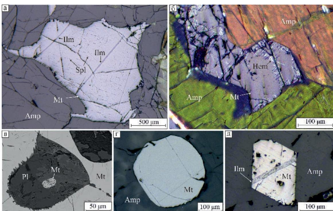
*Рис. 3.* Морфологические типы магнетита: а, б – интерстициальные в амфиболе; в – включение кристалла окружной формы в плагиоклазе; г – кристалл с комбинацией плоскогранной и окружной поверхностей в амфиболе; д – кристалл плоскогранной формы в амфиболе.
