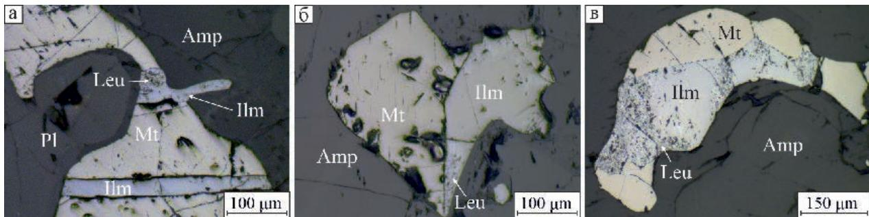
Рис. 6. Варианты присутствия ильменита за пределами магнетита: а – частичное проникновение кристалла ильменита за пределы магнетита; б, в – срастание равновеликих кристаллов магнетита и ильменита в амфибOLE.
