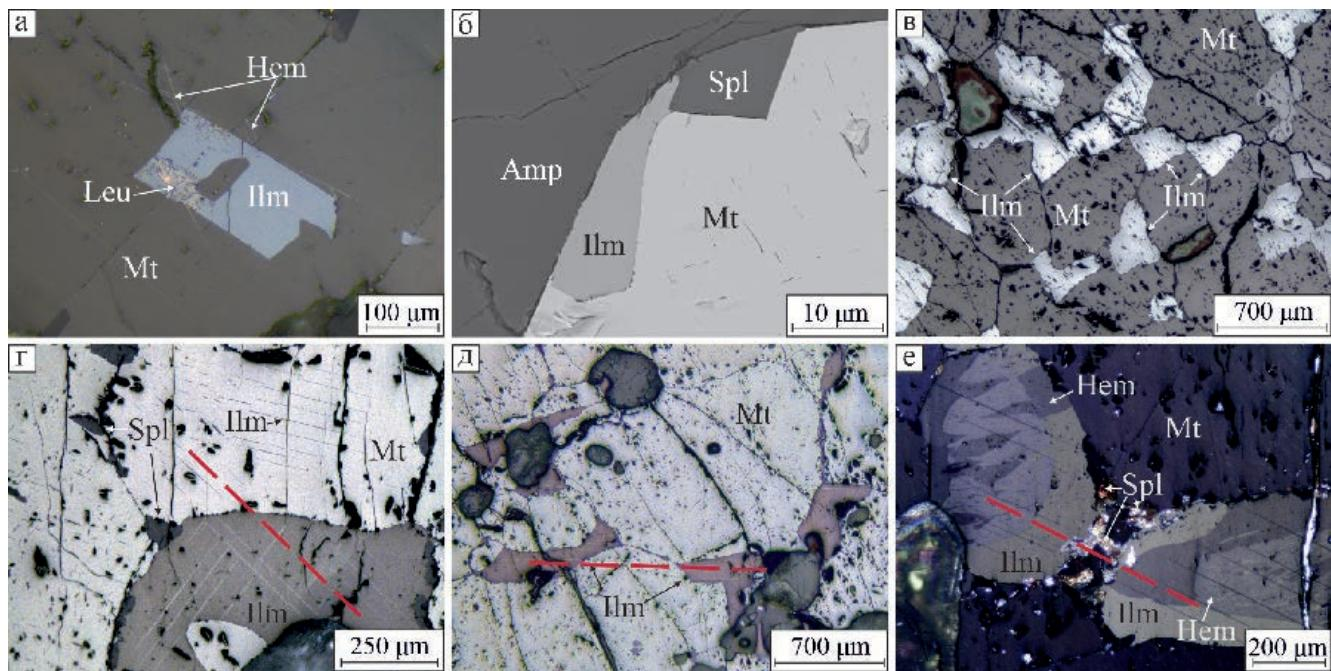
*Рис. 12.* Разная позиция и ориентировка ильменита по отношению к вмещающим минералам: а – на контакте двух разноориентированных зерен магнетита; б – на контакте амфиболя и магнетита; в – зерна совместно с магнетитом; г – параллельная ориентировка пластинчатых двойников в ильмените и пластинок распада шпинели в смежном зерне магнетита; д, е – параллельная ориентировка двойников в различных зернах ильменита (д) и гемоильменита (е).
