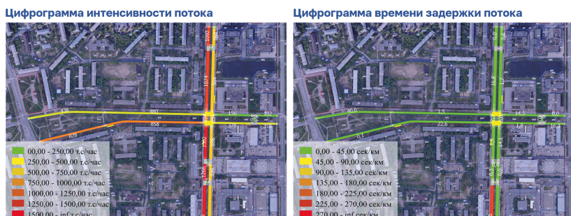
Рис. 6. Картограмма интенсивности движения улично-дорожной сети модели в утренний час «пик» на пересечении улиц Волгоградская и Короленько
