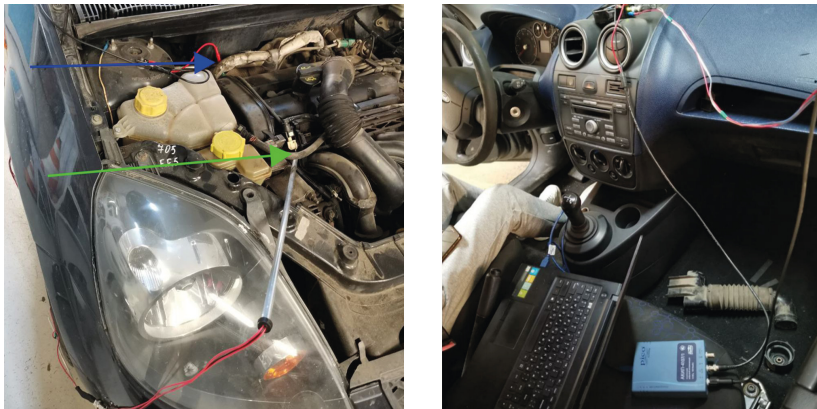
Рис. 2. Подключение измерительного оборудования
