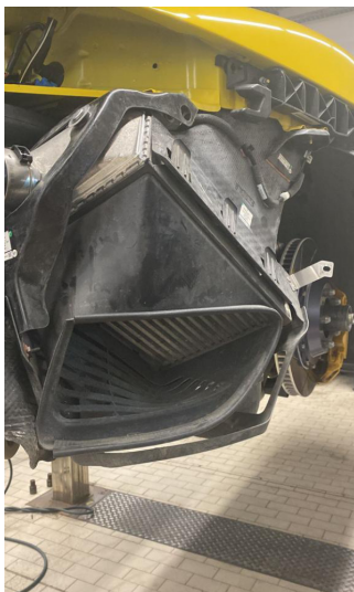
Рис. 5. Корпус интеркулера из углепластика.
