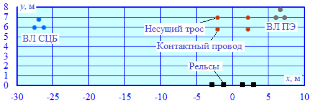
Рис. 3. Расположение токоведущих частей
