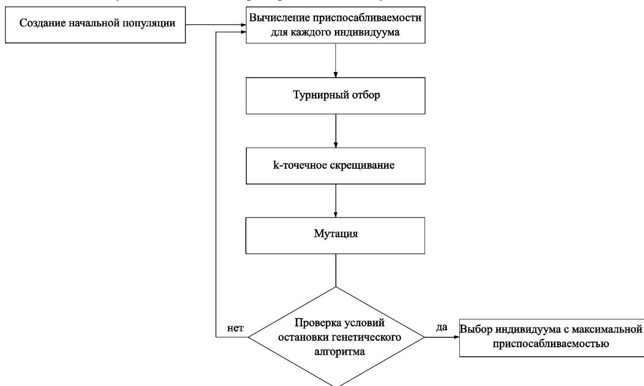
Рис. 2. Схема генетического алгоритма
