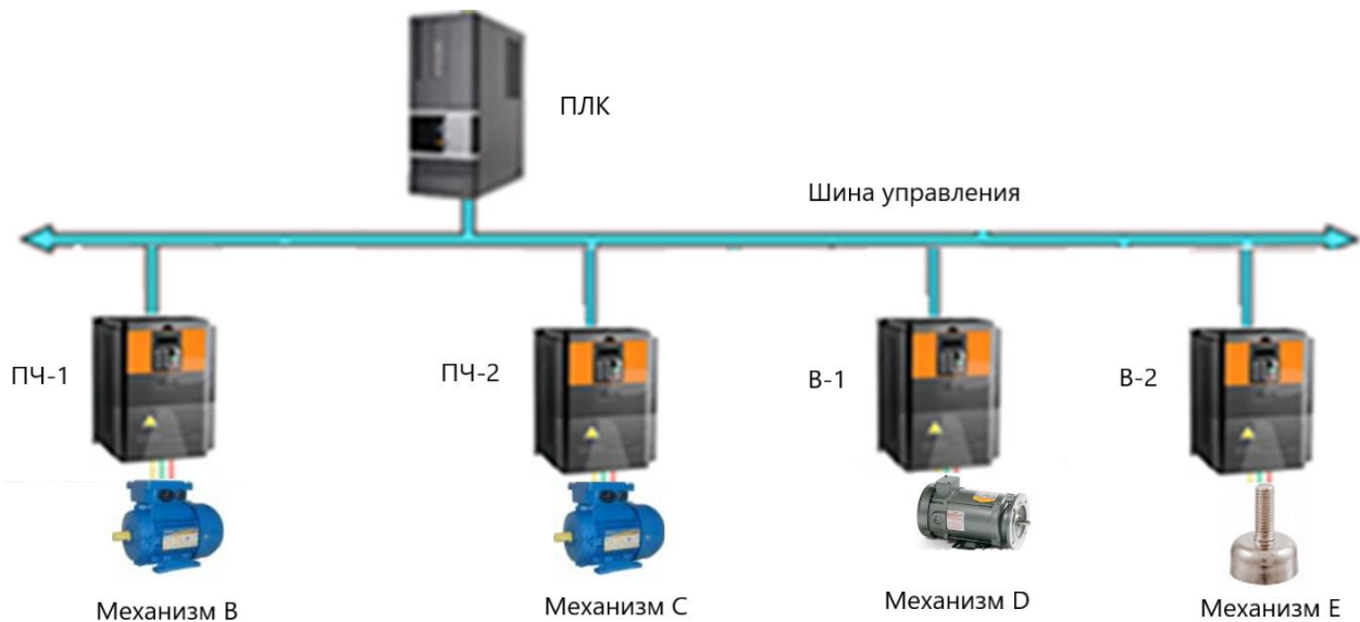
Рис. 2. Функциональная схема системы управления консольного крана с магнитным захватом
