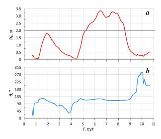
Р и с . 4 . Высота значительных волн (a) и среднее направление волнения (b) в центральной части бух. Коктебель экстремального по штормовому индексу  $SPI = 660 \text{ м}^2 \cdot \text{ч}$  ( $h_s = 2.9 \text{ м}$ , T = 77 ч) шторма (S2) согласно данным SWAN-ERA
