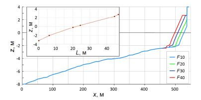
Р и с. 2. Модельные профили динамического равновесия при ширине проектируемого пляжа F10=10 м, F20=20 м, F30=30 м и F40=40 м в центральной части набережной птт Коктебель; на врезке – расчетный профиль для среднего размера частиц 30 мм
