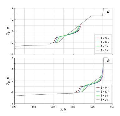
Р и с. 6. Расчетный профиль пляжа F40 (a) и F10 (b) для четырех моментов времени при действии шторма S1
