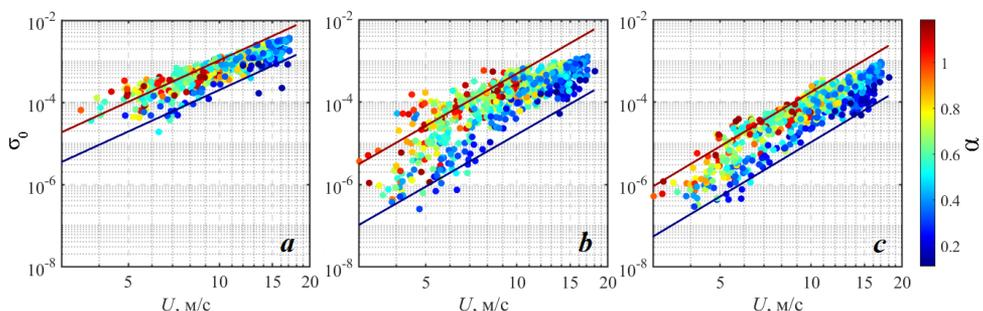
Р и с . 5. УЭПР морской поверхности как функция скорости ветра при зондировании «на ветер» (а), «перпендикулярно ветру» (б) и «по ветру» (с). Сплошные линии соответствуют зависимости (5) с коэффициентами, приведенными в таблице для  $\alpha = 0.1$  (синяя линия) и  $\alpha = 1.2$  (красная линия)
