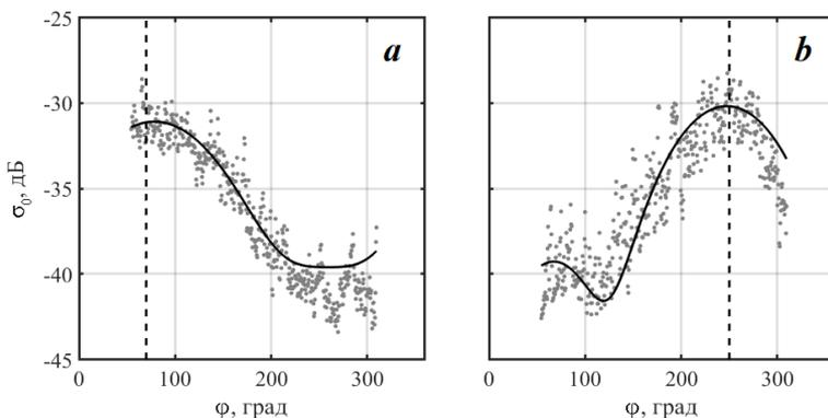
Рис. 7. УЭПР морской поверхности как функция азимутального угла при значениях  $U = 9$  м/с,  $\varphi_U = 70^\circ$ ,  $\alpha = 0.8$  (*a*);  $U = 15$  м/с,  $\varphi_U = 250^\circ$ ,  $\alpha = 0.2$  (*b*). Штриховые линии обозначают направление ветра по измерениям анемометра
