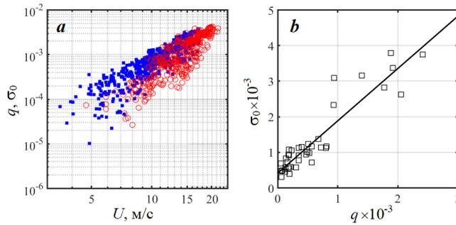
Рис. 6. Доли поверхности, покрытой обрушениями, и УЭПР: *a* – ветровые зависимости  $q$  и  $\sigma_0$  (■ – значения  $\sigma_0^{\text{уп}}$  при  $U = 2.2 \div 17.1$  м/с, ○ – значения  $q$  при  $U = 4.7 \div 21.4$  м/с); *b* – зависимость УЭПР от  $q$ , полученная при синхронных измерениях
