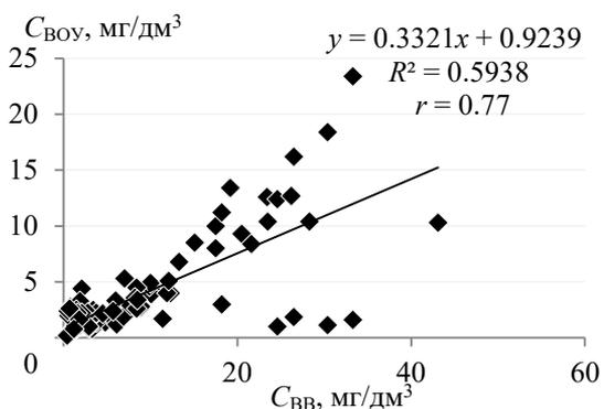
Р и с . 5 . Зависимость концентрации взвешенного органического углерода  $C_{BOY}$  ( $mg/dm^3$ ) от концентрации взвешенного вещества  $C_{BB}$  ( $mg/dm^3$ ) в поверхностном слое в весенний период
