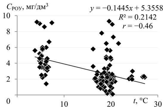
Р и с . 4 . Зависимость концентрации растворенного органического углерода  $C_{POY}$  ( $mg/dm^3$ ) от температуры воды ( $^{\circ}C$ ) в поверхностном слое в весенний период
