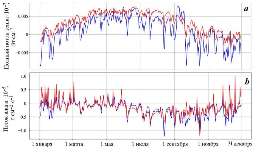
Рис. 3. Суммарные потоки тепла (*a*) и влаги (*b*) в 2016 г. по данным ERA5 (красные линии) и SKIRON (синие линии)
