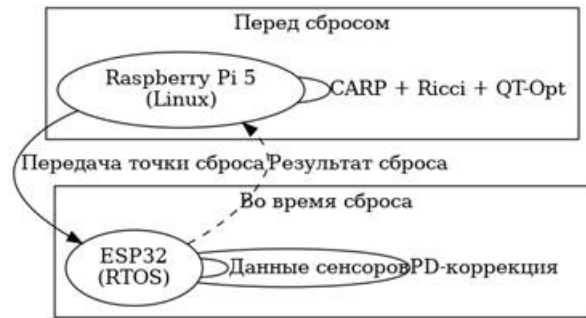
Рисунок 1 – Диаграмма взаимодействия аппаратных узлов системы
