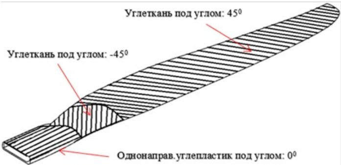
Рисунок 2 – Схема укладки композитной лопасти
