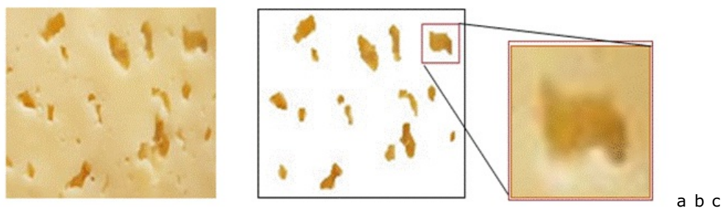
Рисунок 5 – Цифровое изображение среза сыра с порами модель поры нерегулярной формы а – исходное изображение, b – поры, выделенные после бинаризации, с – пора для создания 3D-модели
