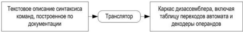
Рис. 16. Иллюстрация автоматизированного порождения кода дизассемблера
