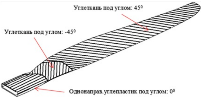
Рисунок 2 – Схема укладки композитной лопасти
