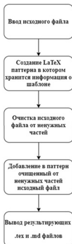
Рисунок 5. Алгоритм работы конвертера Markdown-файла в LaTeX-документ
