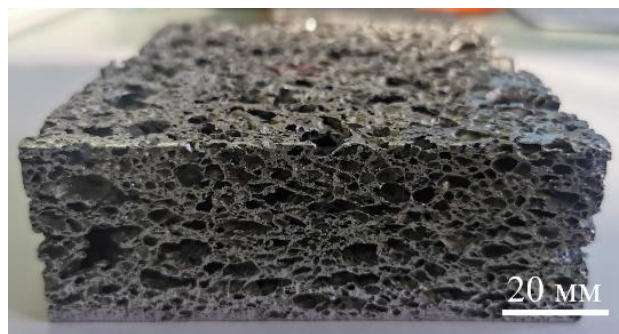
Рис. 1. Фрагмент твердотельного демпфера на основе пеноалюминия
