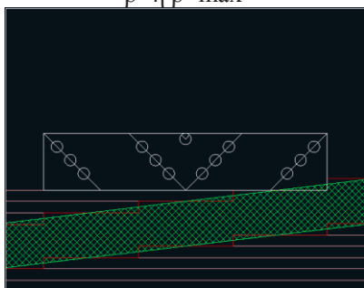
Рис. 1. Технологические схемы образования потерь и засорения полезного ископаемого при отработке слабонаклонных залежей фрезерным комбайном [27]
