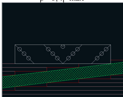
Рис. 1. Технологические схемы образования потерь и засорения полезного ископаемого при отработке слабонаклонных залежей фрезерным комбайном [27]
