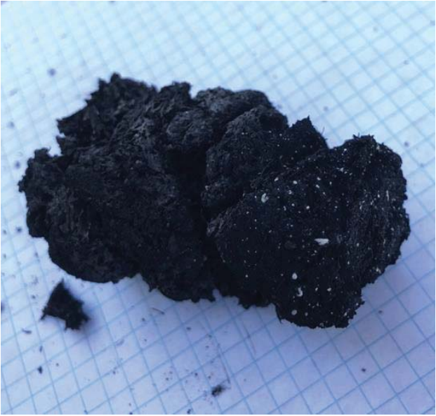
Рис. 3. Биоуголь, полученный при обработке куриного помета индукционным пиролизом при температуре 600 °C
