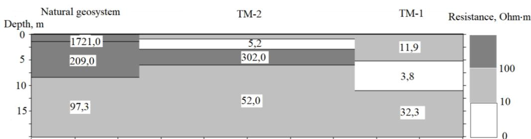
Рис. 7. Геоэлектрический разрез через зону влияния отвалов фосфогипса
