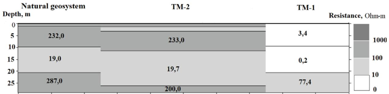
Рис. 10. Геоэлектрический разрез через зону влияния склада серы, Ом·м
