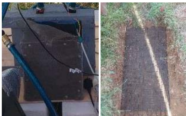
Рис. 8. а) радиатор от мотоблока; б) конденсатор от холодильника размером 520×1000 Fig. 8. a) radiator from the tillerblock; b) condenser from the refrigerator with dimensions of 520×1000
