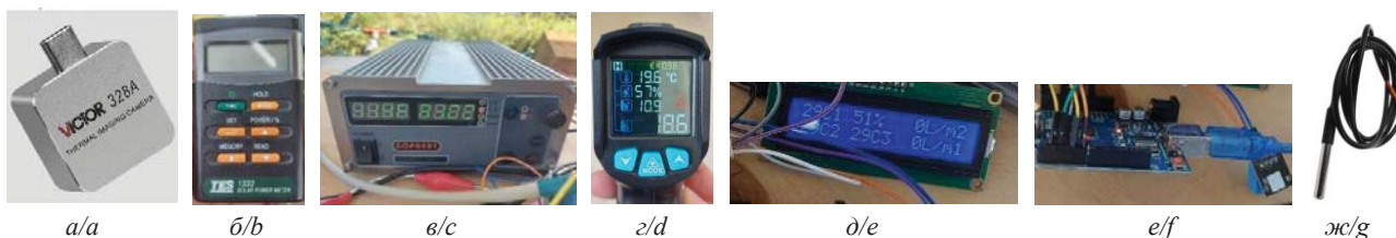
Рис. 9. Приборы и датчики для измерения показателей охлаждения и нагрева ФЭМ: а) инфракрасная камера VIRTOR VC328A 256×192; б) прибор для измерения солнечной радиации TES 1333 SOLAR POWER METER; в) источник постоянного тока GOPHERT CPS-6011 0–60 В 0–11 А; г) пирометр Mestec IR02C; д) плата Arduino UNO; е) датчик температуры и влажности DHT 11; ж) датчики температуры D18B20 Fig. 9. Devices and sensors for measuring cooling and heating parameters of FEM: a) infrared camera VIRTOR VC328A 256×192; b) device for measuring solar radiation TES 1333 SOLAR POWER METER; c) direct current source GOPHERT CPS-6011 0–60 V 0–11 A; d) pyrometer Mestec IR02C; e) Arduino UNO board; f) DHT 11 temperature and humidity sensor; g) D18B20 temperature sensors
