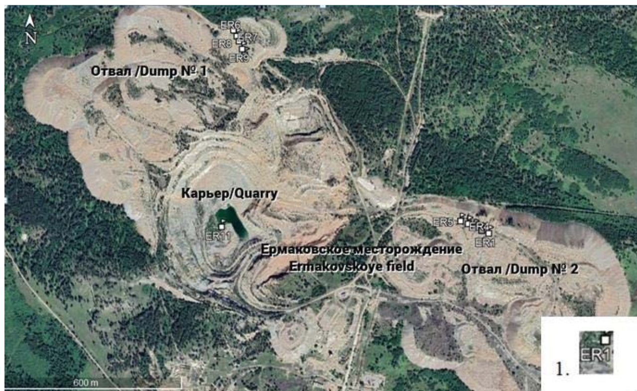
Рис. 2. Спутниковый снимок со схемой опробования конденсационной влаги. Условные обозначения: 1 – места отбора проб конденсата
