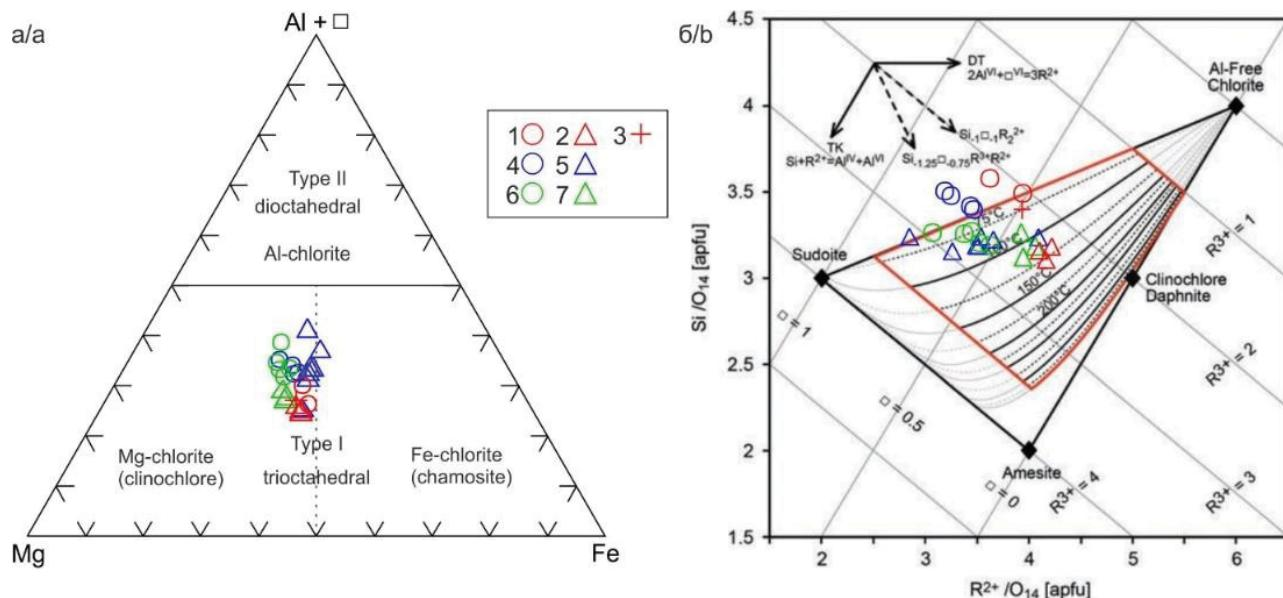
**Рис. 3.** Состав и оценка температуры кристаллизации хлоритов из пород экзоконтакта: а) классификация  $Mg-Al+Y-Fe$  (ф.е.) по [11]; б) диаграмма  $R^{2+}-Si$  (ф.е.) [12] с изотермами [13]. 1–3 – метааргиллиты: 1, 2 – обр.  $k_{23-78}$ : 1 – матрикс, 2 – метакристаллы, 3 – обр.  $k_{23-82}$ , матрикс; 4, 5 – силикатно-карбонатные метасоматиты, матрикс: 4 – обр.  $k_{23-80a}$ , 5 – обр.  $k_{23-81}$ ; 6, 7 – скарнированный известняк, обр.  $k_{23-84}$ : 6 – матрикс, 7 – стилолит
