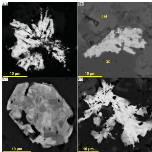
**Рис. 4.** BSE изображения главных акцессорных РЗЭ-содержащих минералов: а, б) розетковидные срастания кристаллов синхизита-(Ce) в силикатно-карбонатных метасоматитах: а) обр.  $k_{23}-80a$ ; б) обр. Dз-16; в, г) РЗЭ-содержащий клиноциозит: в) идиоморфный неоднородный кристалл в силикатно-карбонатном метасоматите, обр.  $k_{23}-81$ ; г) срастание удлиненных кристаллов в метааргиллите, обр. 60-6
