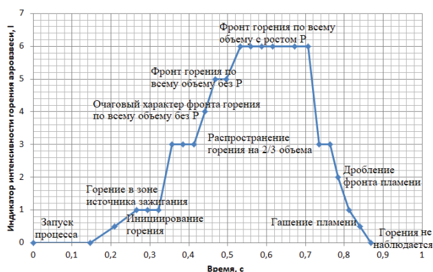
Рис. 2. Зависимость интенсивности взрывного горения аэровзвеси в реакционном объеме от времени протекания процесса
