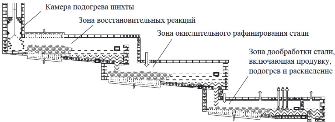
Рис. 3. Перспективная модель системы по производству стального листа Fig. 3. Promising model of a steel sheet production system
