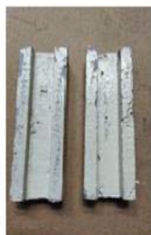
Рис. 10. Лабораторные образцы ангидритовых швеллеров размером 240×60×30 мм
