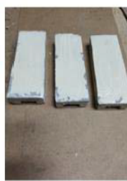
Рис. 10. Лабораторные образцы ангидритовых швеллеров размером 240×60×30 мм
