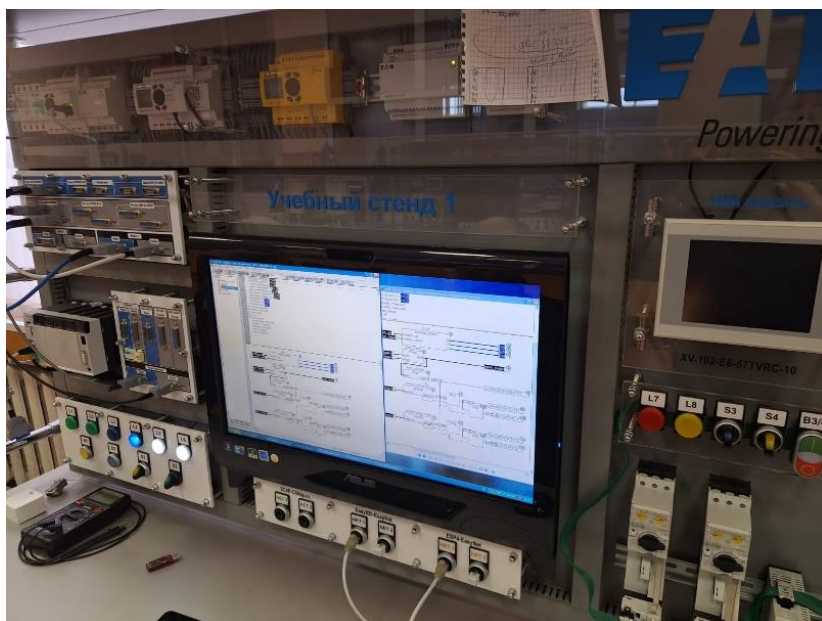
Рис. 4. Вычислительная система стенда в составе ПЛК и персонального компьютера Fig. 4. Computing system of the stand consisting of a Programmable logic controller PLC and a personal computer
