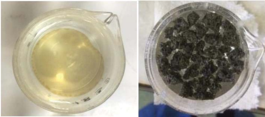
Рис. 2. Поглощение нефтяной пленки фосфатным сорбентом [32] Fig. 2. Absorption of oil film by phosphate sorbent [32]
