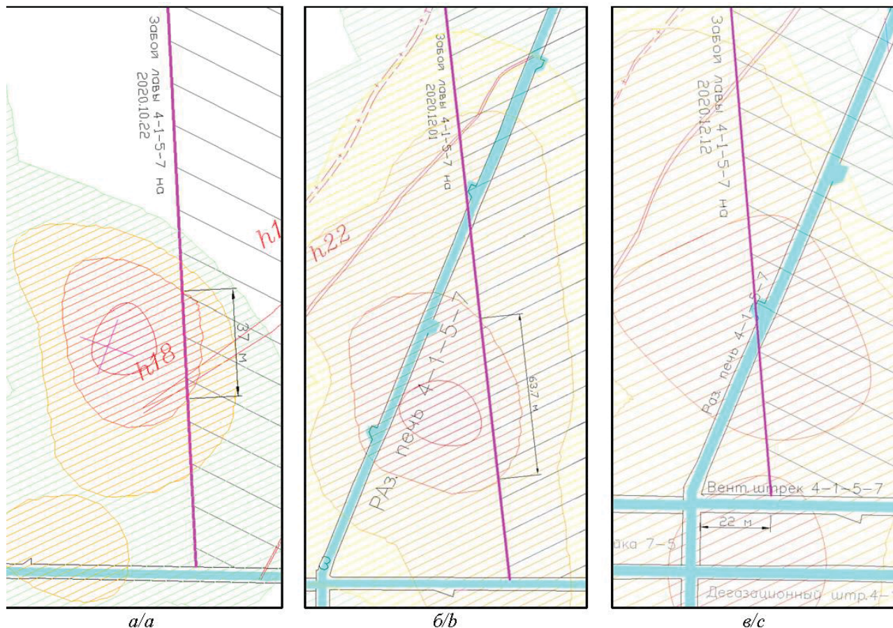
Рис. 4. Параметры зоны повышенного сейсмозергвыделения в выработке при переезде забоем лавы: а) группы тектонических нарушений; б) передовой выработки; в) в вентиляционном штреке 4-1-5-7 (Палитра для окрашивания зон по параметру F соответствует табл. 3)
