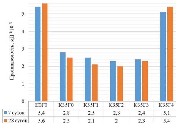
Рис. 9. Проницаемость образцов цементного камня после хранения в высокотемпературных условиях (один термоцикл)
