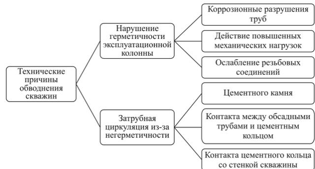
Рис. 2. Технические причины обводнения скважин
