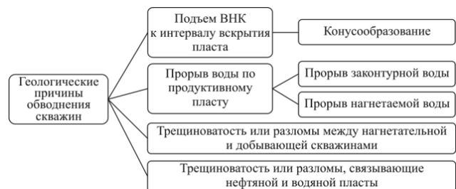
Рис. 3. Геологические причины обводнения скважин
