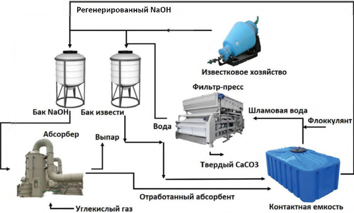
Рис. 2. Технологическая схема блока сорбции углекислого газа Fig. 2. Technological diagram of the carbon dioxide sorption unit
