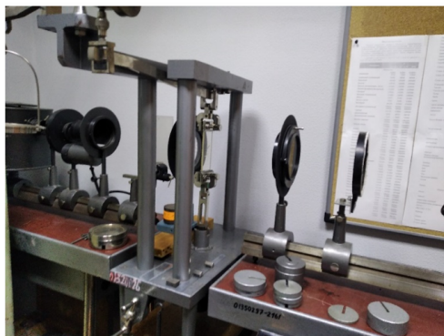
Рис. 3.1. Экспериментальная поляризационно-проекционная установка ППУ-7 Fig. 3.1. Experimental setup
