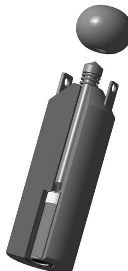
Рис. 2. Патрон с наколом дополнительным грузом
