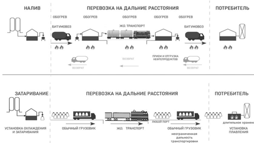
Рис. 1. Принципиальные схемы транспортировки жидких и фасованных битумных вяжущих
