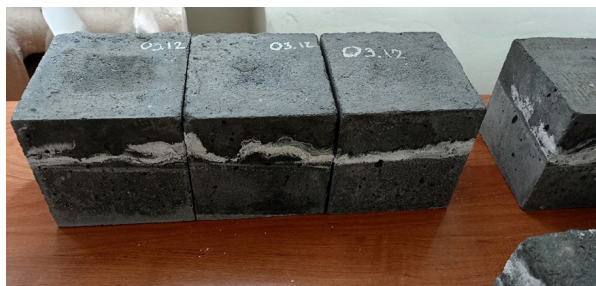
Рис. 2. Внешний вид образцов торкрет-бетона после выдержки в растворе щелочи Fig. 2. Appearance of shotcrete samples after exposure to an alkali solution
