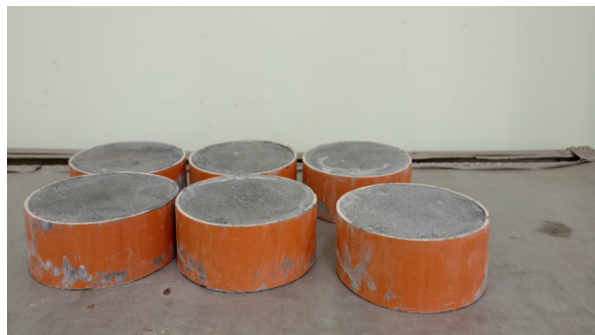
Рис. 1. Торкрет-бетонные образцы. Внешний вид перед испытанием Fig. 1. Shotcrete samples. Appearance before testing
