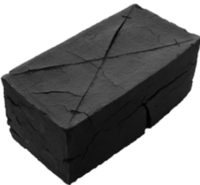
Рис. 4. Кирпич из глины Смышляевского месторождения, обожженный на Тольяттинском кирпичном заводе в туннельной печи при температуре 1000 °С Fig. 4. Clay brick from the Smyshlyaevsky deposit, fired at the Tolyatti brick factory in a tunnel furnace at a temperature of 1000 °С
