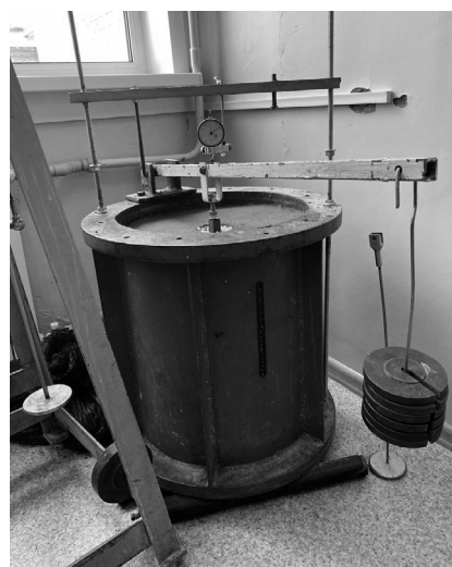
Рис. 1. Лабораторная установка по статическому испытанию свай Fig. 1. Laboratory installation for static testing of piles
