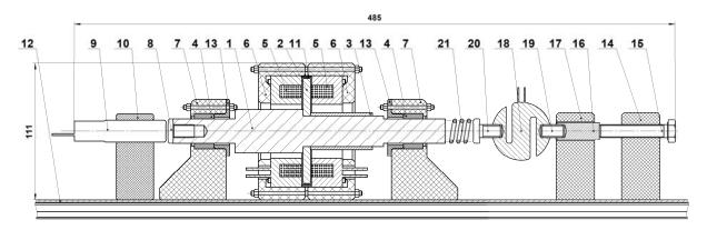
Рис. 2. Схема экспериментальной установки для исследования динамики осевого магнитного подвеса ротора
