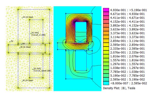
Рис. 4. Конечно-элементная модель одностепенного магнитного подвеса ротора и распределение магнитной индукции
