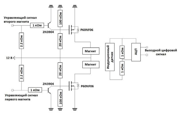
Рис. 3. Электронная схема системы управления экспериментальной установки
