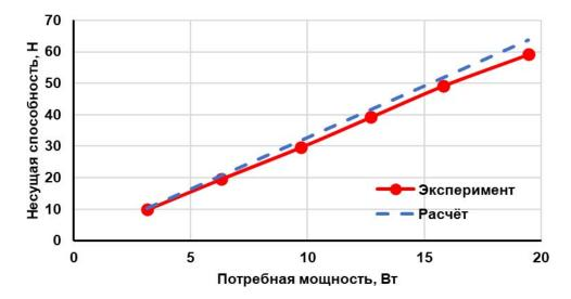
Рис. 5. Сравнение экспериметальной и расчётной несущей способности освого активного магнитного подшипника
