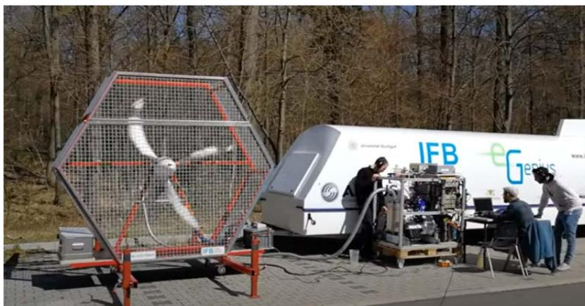
*Рис. 1. Экспериментальный стенд гибридной силовой установки самолёта e-Genius*
