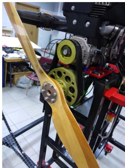
Рис. 6. Компоновка электрического мотор-генератора в гибридной силовой установке на базе поршневого двигателя
