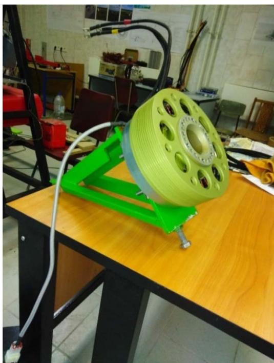
Рис. 5. Мотор-генератор для гибридной силовой установки
