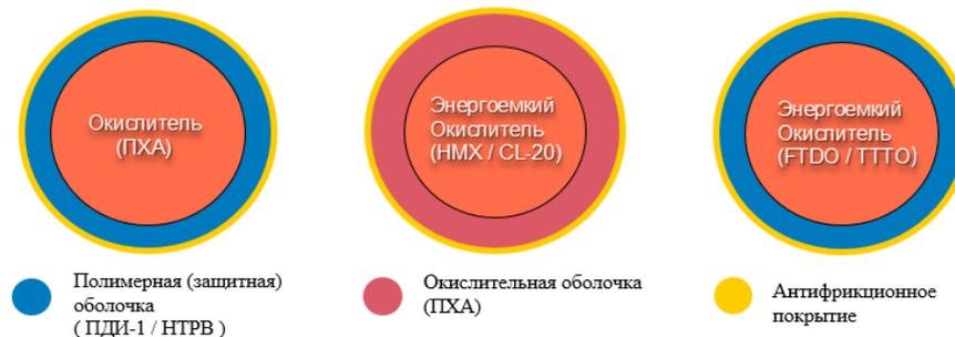
Рис. 1. Частные концепции гранулированного топлива
