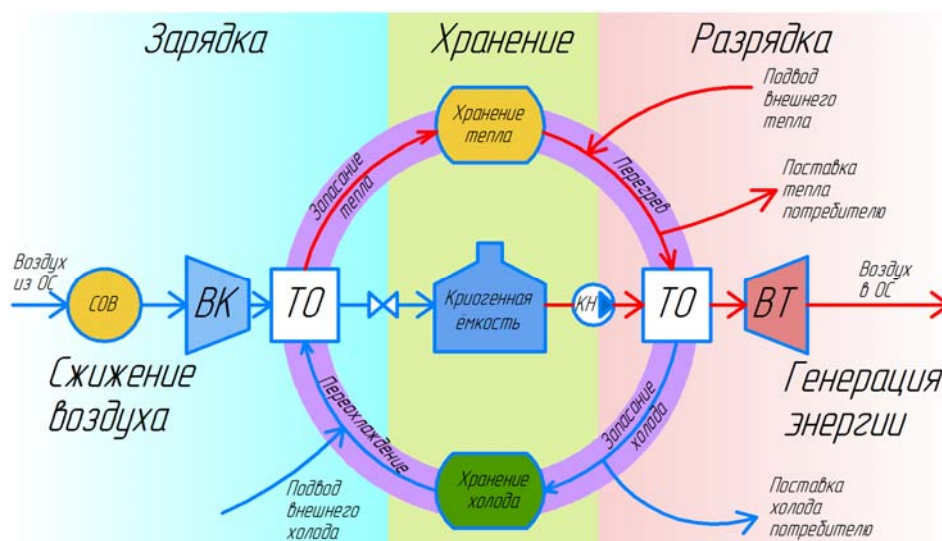
Рис. 1. Схема устройства криогенного аккумулятора энергии [21]
