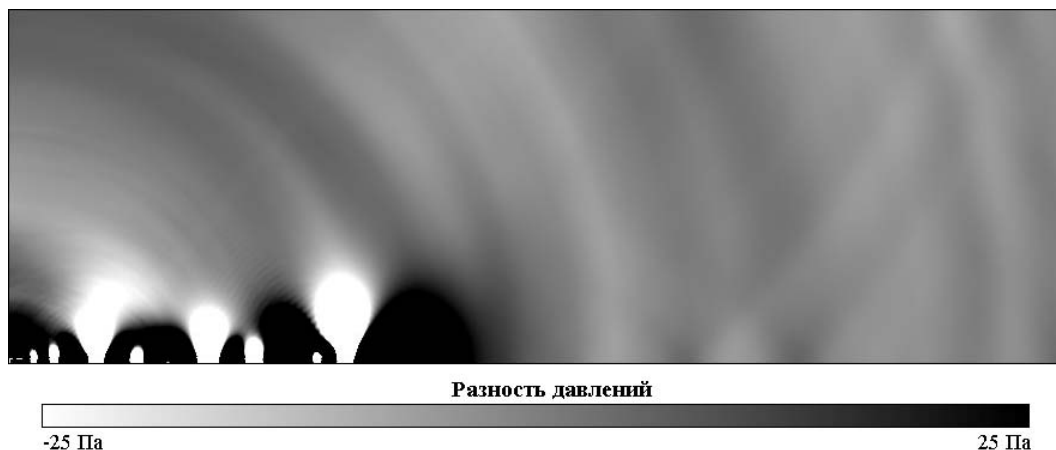
Рис. 3. Поле давления из 2D расчёта
